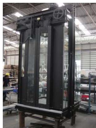
ลิฟต์ห้องโดยสารทั้ง 3 ด้านเป็นกระจกใส
