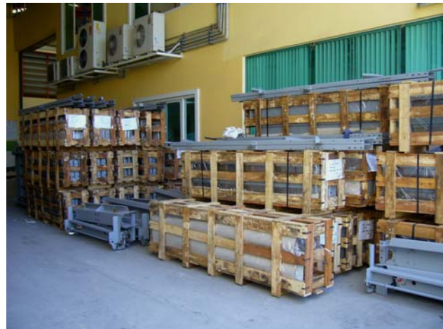
พื้นที่ผนังห้องโดยสารลิฟต์ บ้านประตูลานพักลิฟต์ ผลิตแล้วเสร็จ รอขนส่งเข้าหน่วยงานติดตั้ง
