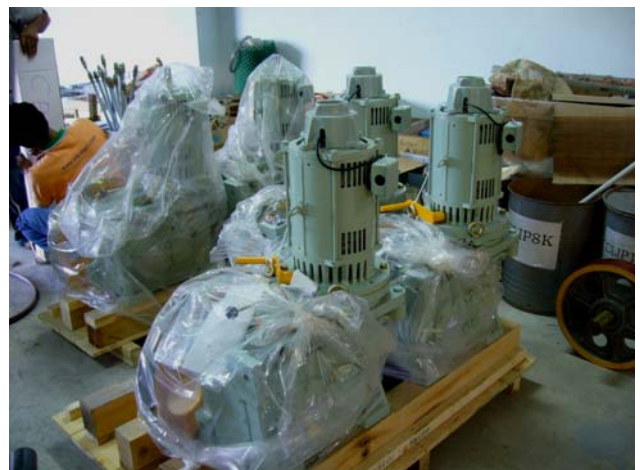
สต็อกเครื่องมอเตอร์ขับเคลื่อนลิฟต์โดยสาร มอเตอร์ MITSUBISHI
